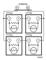
Fig. 27. Wiring four T7770A1006 (20K ohm) Sensors.
