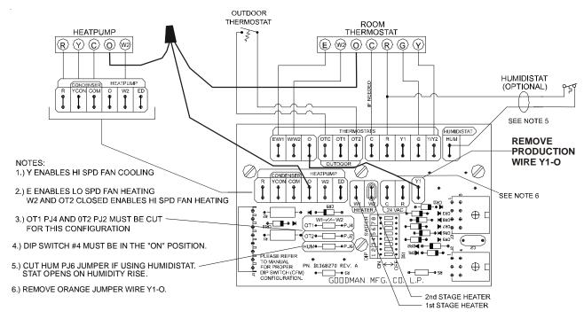
NO AUX HEAT IN HEATPUMP MODE UNTIL OUTDOOR T'STAT CLOSES
