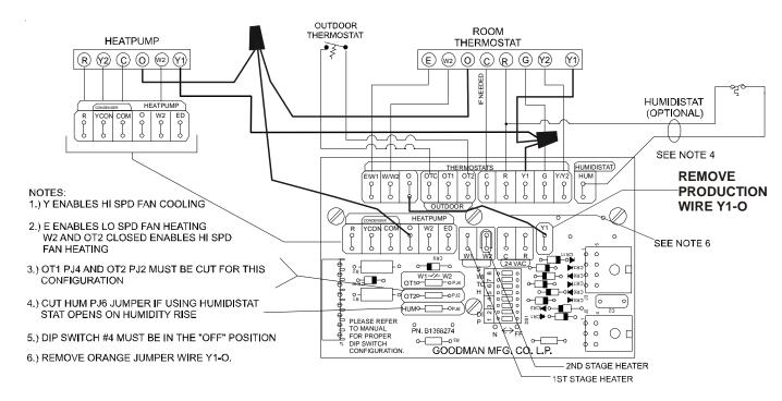
NO AUX HEAT IN HEATPUMP MODE UNTIL T'STAT CLOSES
