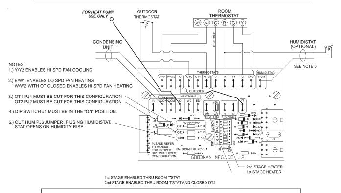
COOLING ONLY - 2 STAGE HEAT (T'STAT ENABLED OT)
