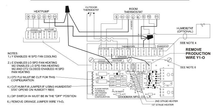
1ST STAGE AUX HEAT ENABLED BY ROOM T'STAT 2ND STAGE AUX ENABLED BY ROOM T'STAT AND OUTDOOR T'STAT
