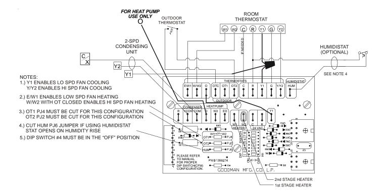
2 SPD COOLING ONLY - 2 STAGE HEAT (T'STAT ENABLED OT)
