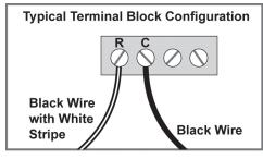
Fig. 1 HVAC Wiring
